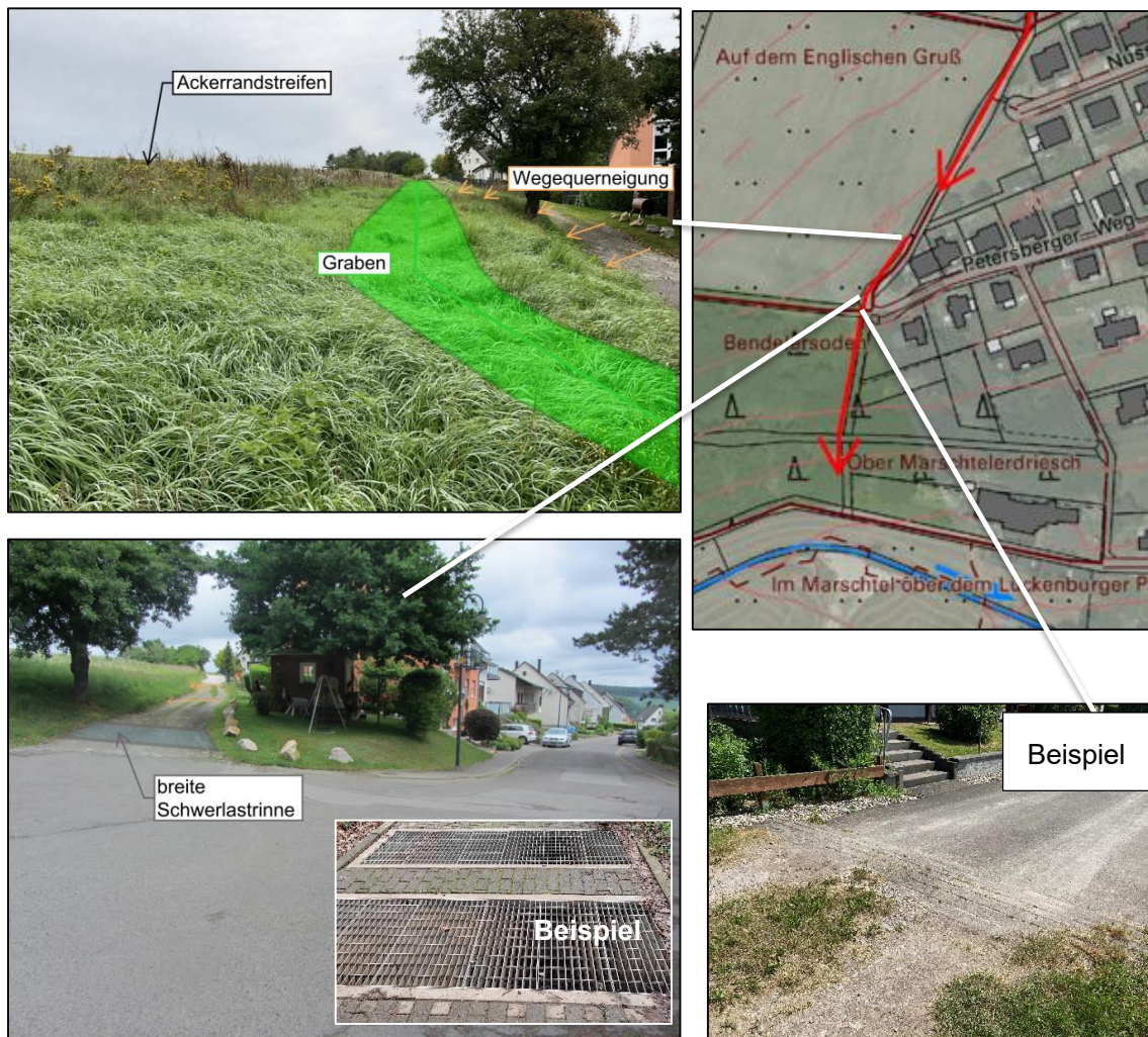
Abbildung 87: Möglichkeit für Außengebietsentwässerung am „Petersberg“ - Notabflussweg
